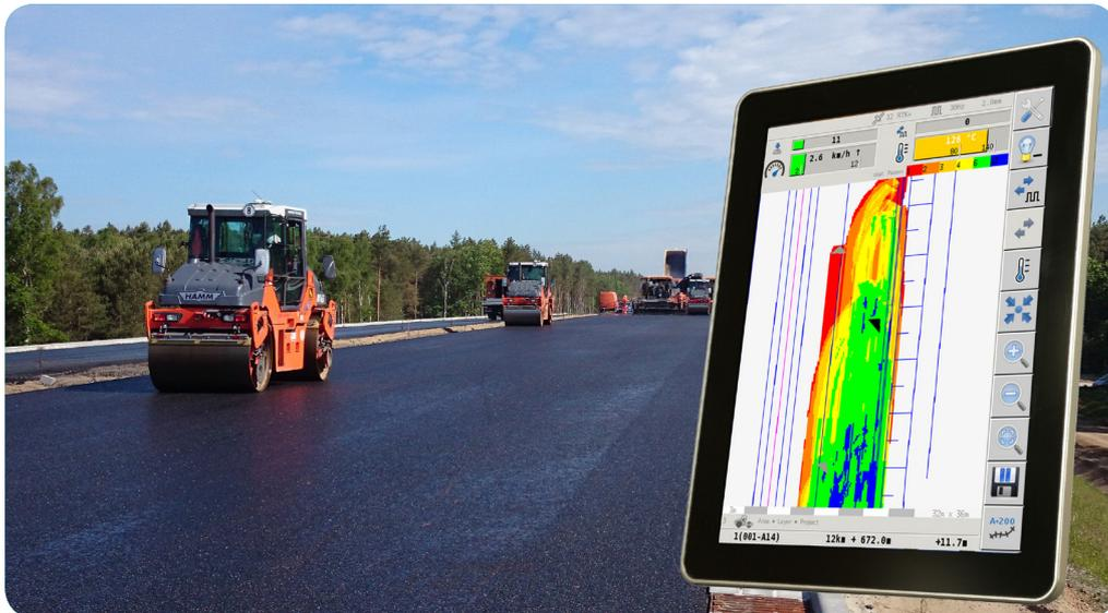
Wer baut, will sichergehen, dass sein Bauvorhaben auf solidem Grund steht. Daher verlangen immer mehr Bauherren den Nachweis, dass der Unterbau tragfähig ist. Dies hängt maßgeblich von dessen Verdichtung ab. Faktoren wie zu viel oder zu wenig Wasser im Boden, eine schlechte Kornstruktur oder gar eine zu leichte Walze können die Verdichtung – und damit die Tragfähigkeit des Bodens – beeinträchtigen.
