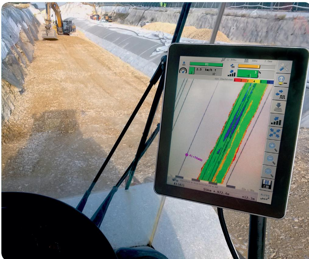
Dank zuverlässiger M2M-Kommunikation lässt sich die Verdichtung auch vor Ort auf einem Tablet-ähnlichen Maschinendisplay kontrollieren.
